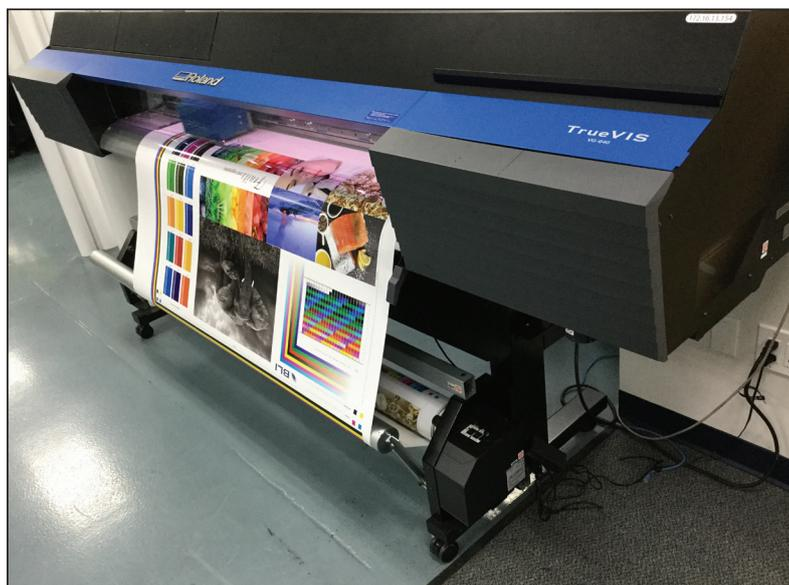
オプションで用意されている巻き取り装置は、複数のジョブを続けて出力したり、長尺物の出力でも容易に巻き取れ、無人印刷に対応します。
