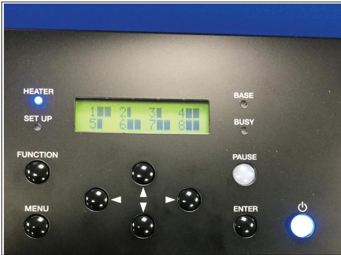
コントロールパネルのインクインジケータには、1本または2本の目盛りが表示され、インクレベルの残量を示します。また、カラー名ではなく、各インクトレイ番号が表示されます。プリンターのインクカラー設定によって、インクカラーを装置の別のスロットにセットできるため、このように表示されます。
