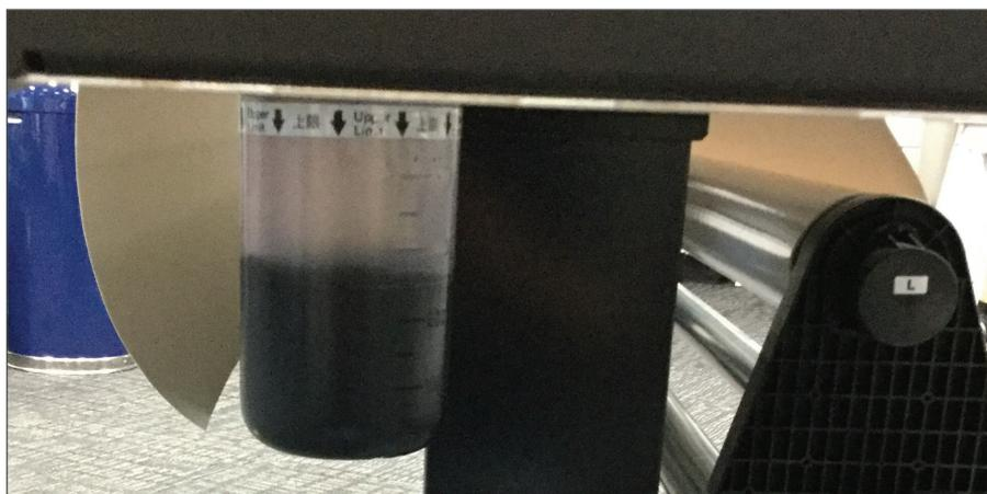
装置の廃インクタンクは簡単に取り外すことができます。オペレーターは、廃インクタンクを回して外し、廃インクを処分します。ユーザーには、出力量を計算し、「廃液を捨ててください」のメッセージがコントロールパネルに表示されます。
