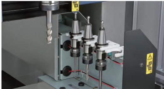
荒削りから仕上げまで、最適なツールを選択しツール交換の手間を軽減する4スロットのオートツールチェンジャーを標準装備。手間のかかる刃長測定や原点設定も自動的にを行い、データ送信から仕上げ加工終了まで自動で行います。
