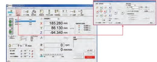
操作に合わせて画面が変わる新感覚の対話形式方法を可能にする「VPanel」。操作に不要なメニューは表示されず、最適なメニューのみが表示されます。また、NCデータにも対応し「VPanel」からの直接の出力が可能です。
