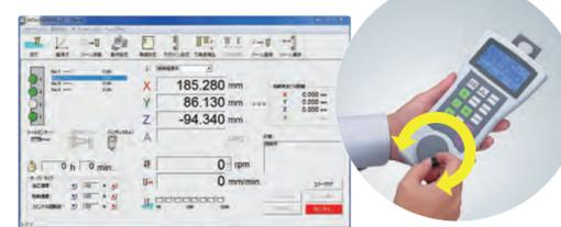
よく使う機能を集約し、直感的に使えるハンディーパネル。原点位置の移動や回転数の設定は、ロータリーハンドルを使って簡単に設定が可能。
